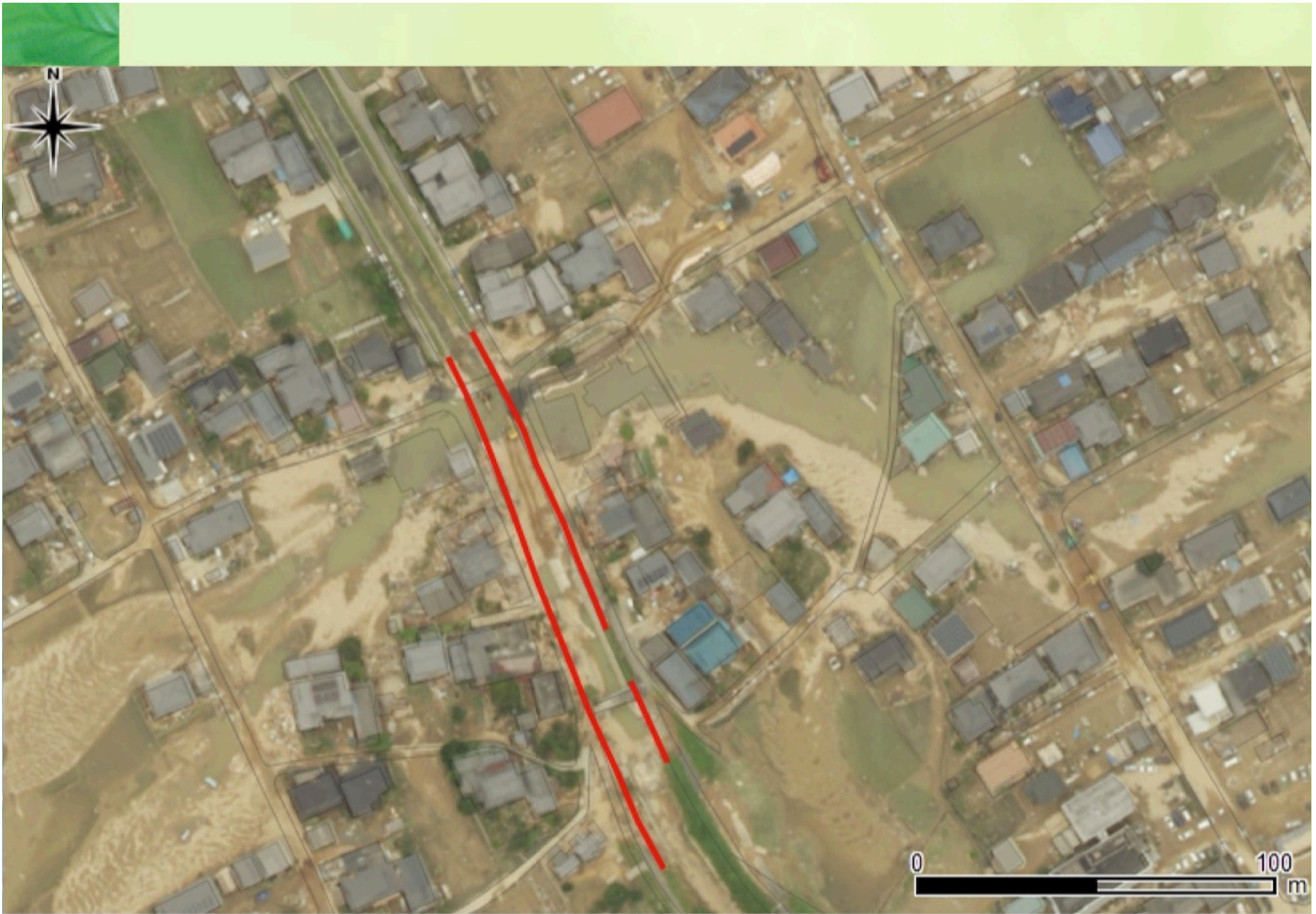
末政川の破堤箇所 ① に形成された押堀と土砂の堆積 (空中写真は9月11日国土地理院撮影)
