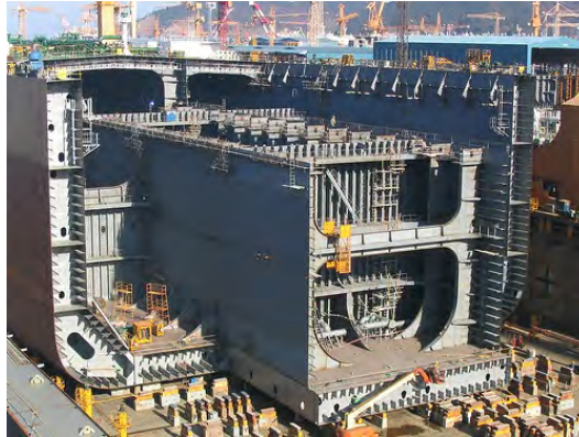
図 4 ドック内でのブロック組み立て
