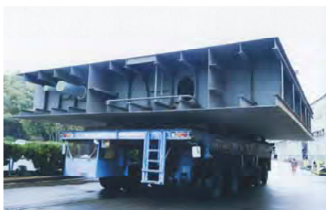
図3 キャリー（耐荷重数百トンの自走台車）
