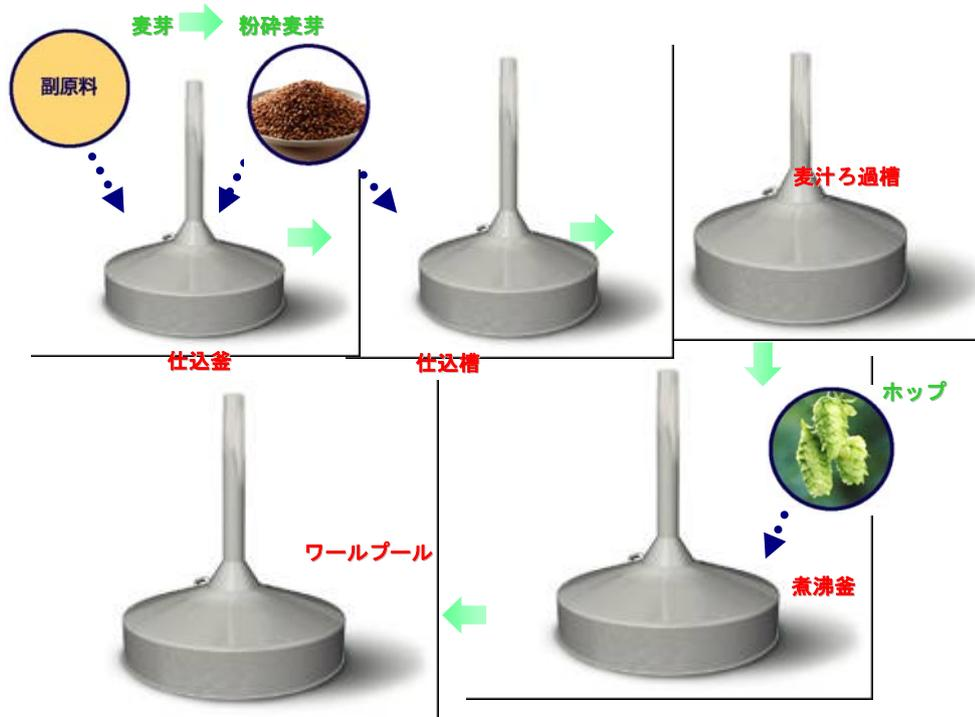
図 3 : 仕込工程の設備
