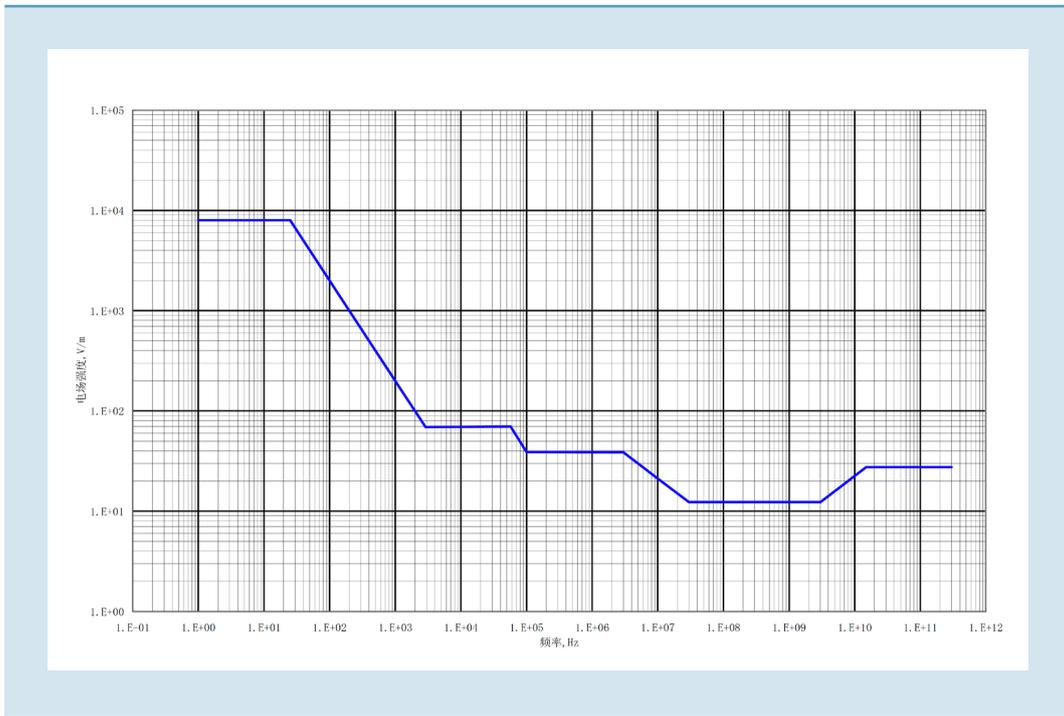
图 1.4-2 公众暴露电场强度控制限值与频率关系
