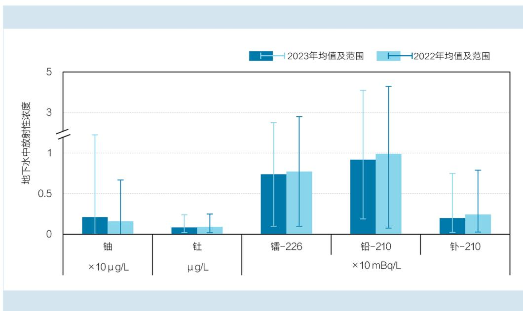
图 3.3.4-2 地下水监测结果汇总及年际变化
