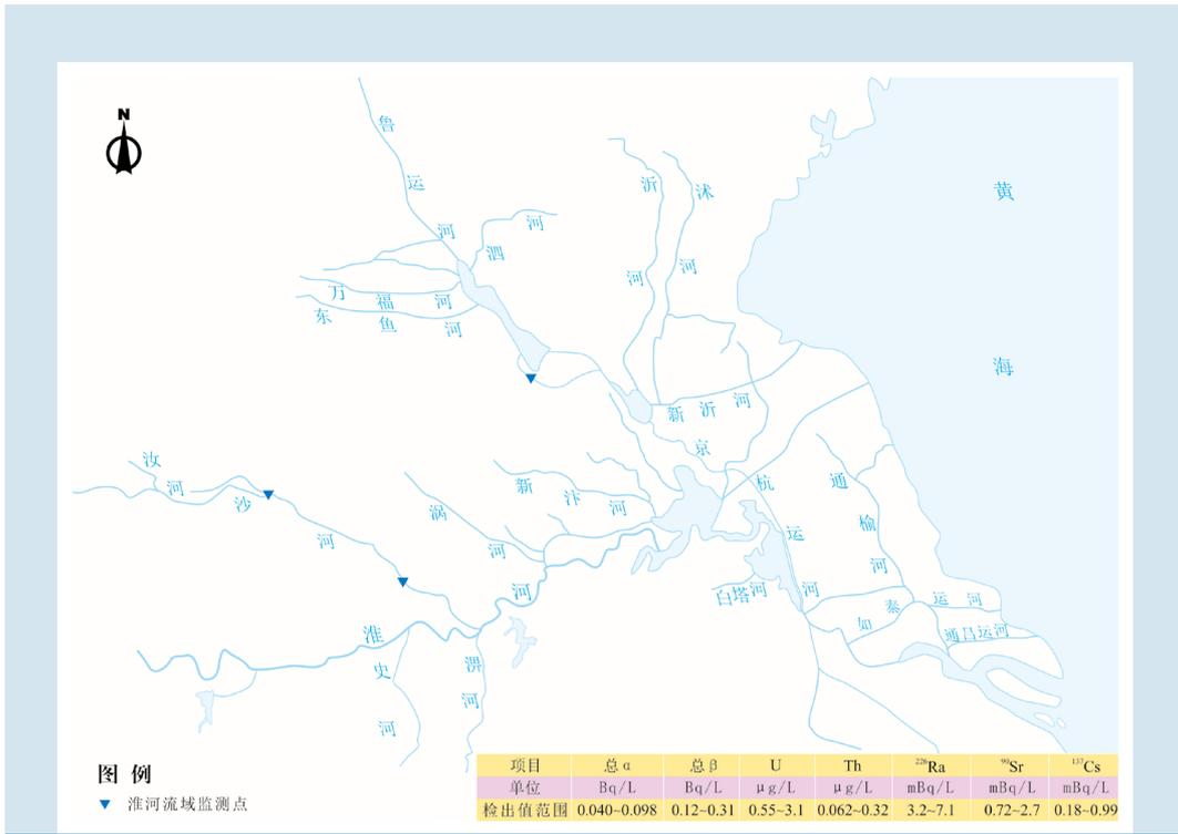
图 3.3.1-6 淮河流域布点和监测结果示意图
