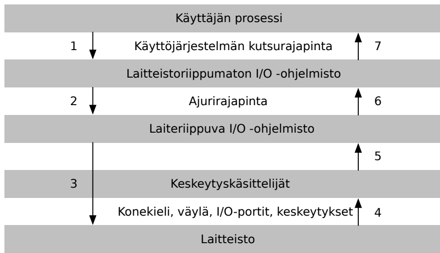
Kuva 31: I/O -operaatioon osallistuvat kerrokset, niiden väliset rajapinnat, ja operaation suoritusvaiheet ja osapuolet aikajärjestyksessä (1–7).
