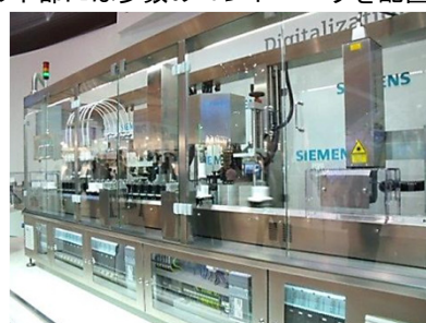
図表3-4 独Siemens 顧客のインターネット経由の注文 (写真左) を即座に自動製造ライン (写真中) に反映 製造装置の下部には多数のコントローラを配置 (写真右)
