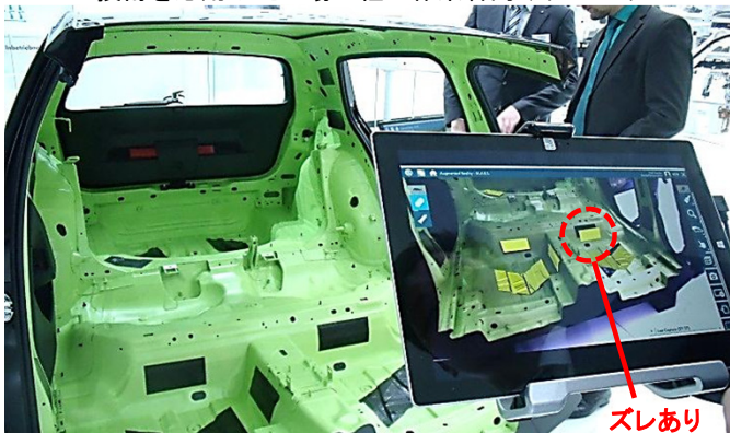
図表5-3 VW 拡張現実(Augmented Reality)技術を応用した工場の組立作業向けタブレット
