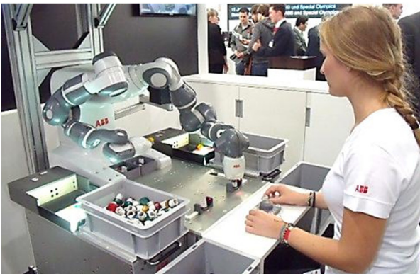
図表5-1 ABB 人と協調しながら安全に作業ができる双腕ロボット‘YuMi’
