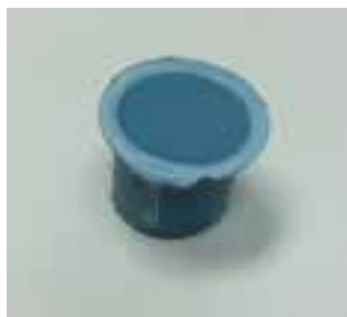
Probetas que muestran que el taladrado se ha producido por arrastre en la pared interior
