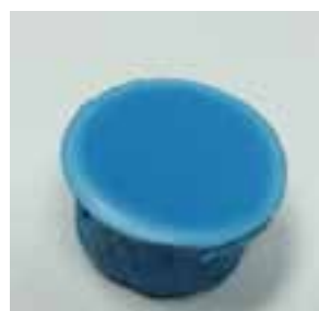
Probetas que muestran que el taladrado se ha producido por arrastre en la pared interior
