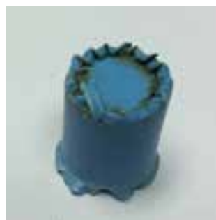
Probetas que muestran la corona en la superficie exterior
