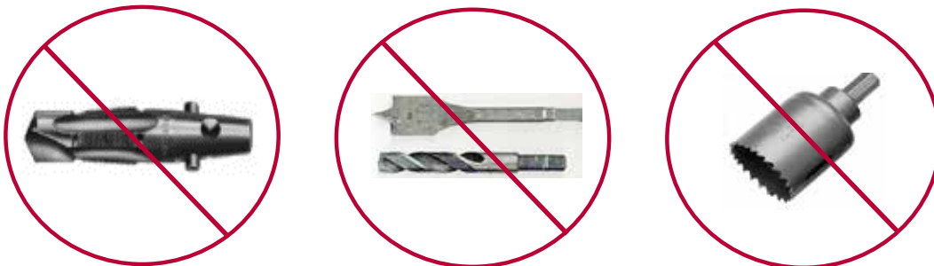
Brocas de taladrado inadecuadas
