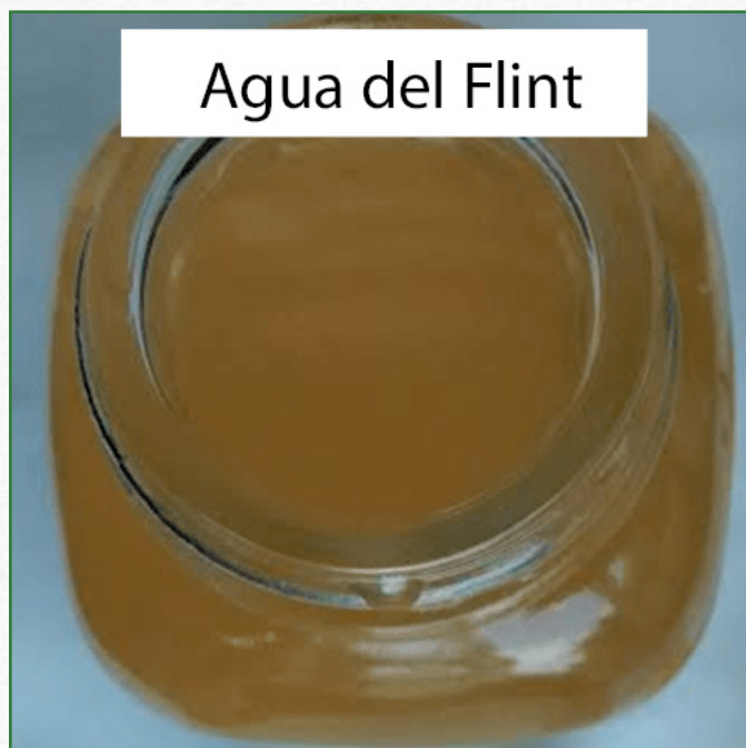
FIGURA A.24 : LA CORROSIÓN DEL HIERRO CAUSA AGUA “ROJA” U OXIDADADA
