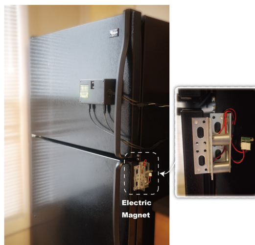
図 4. 冷蔵庫に HappinessCounterBox と電子錠を取り付けた．
