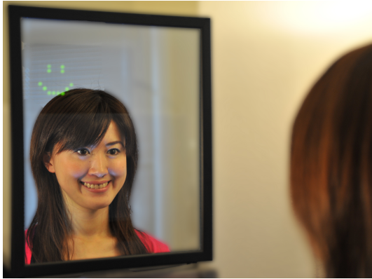
図 1. HappinessCounter システム．笑顔を検出すると、スマイルアイコンと音によるフィードバックを与える．
