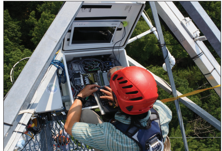
Equipamentos e apoio técnico. Apoio técnico. Stephen Chan analisa o sistema portátil de covariância de vórtices AmeriFlux (PECS, da sigla em inglês), comparando dados com o sistema do site US-UMB. Crédito da foto: Chris Vogel.
