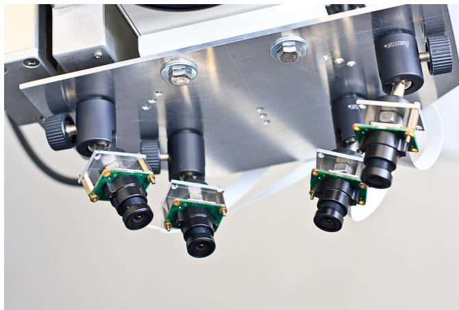
Abbildung 5.9.: Die Multisensor-Kamera am Operationsmikroskop
