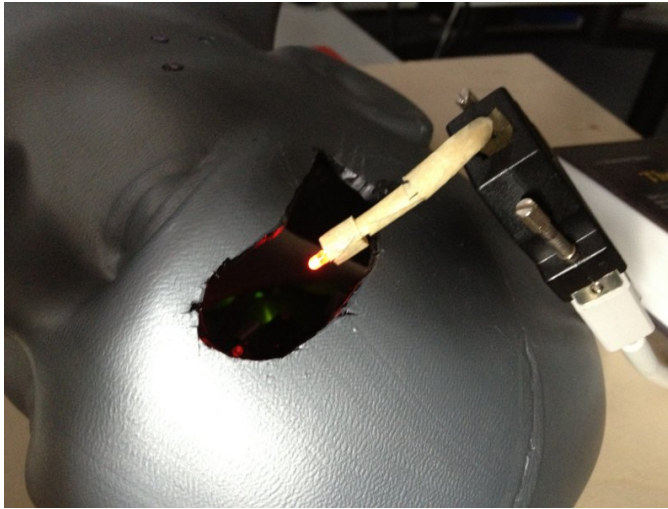
Abbildung 4.19.: Aufbau der Latenzmessung mit LED
