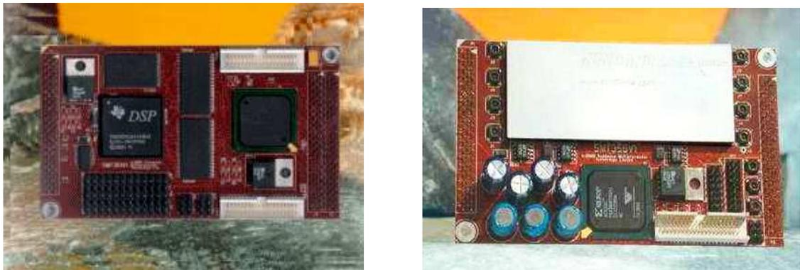
Figure X: Il modulo DSP-FPGA Sundance -sinistra- e il modulo ADC ad 8 canali -destra-
