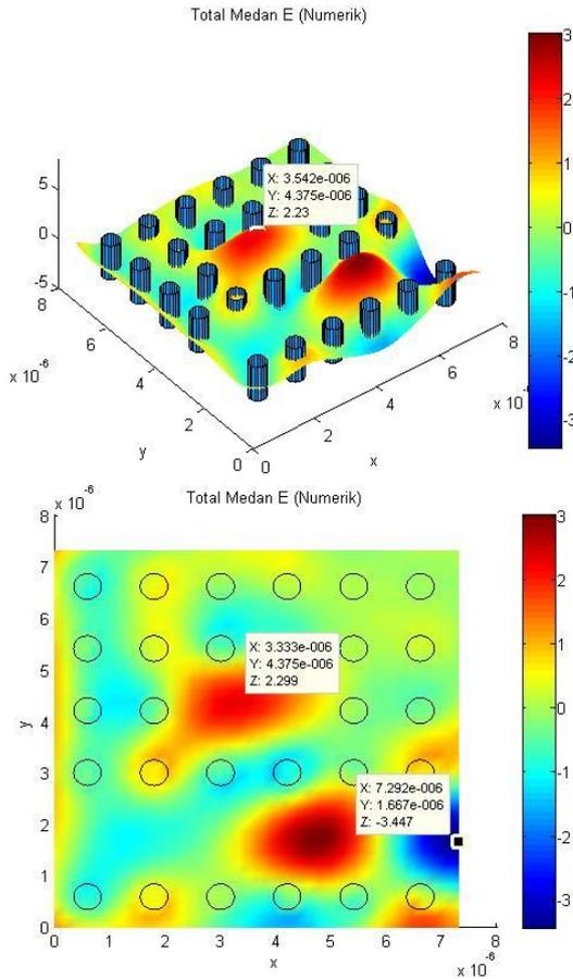
**Gambar 16** Simulasi kopling medan EM TM pada Kristal fotonik 2D dengan frekuensi  $\frac{\omega a}{2\pi c} = 0,39$
