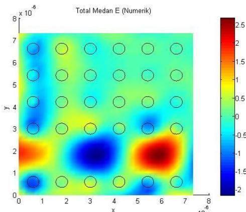
**Gambar 12** Perambatan gelombang EM TM dalam sebuah kanal pandu gelombang pada kristal fotonik 2D
