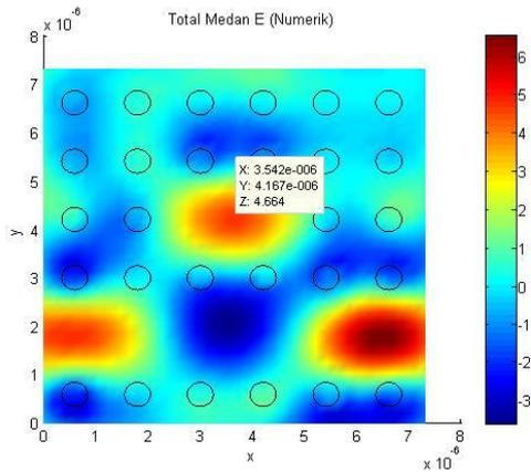
**Gambar 13** Simulasi kopling medan EM TM pada Kristal fotonik 2D dengan frekuensi  $\frac{\omega a}{2\pi c} = 0,36$
