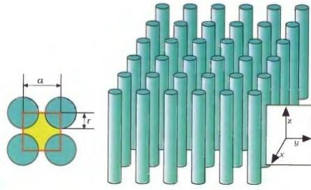
**Gambar 2** Kristal fotonik 2D yang terdiri atas kolom-kolom dielektrik dengan jari-jari  $r$  dan konstanta dielektrik  $\epsilon_r$ . Material ini homogen pada sumbu  $z$  (digambarkan seperti silinder yang panjang), dan periodik pada bidang  $x$ - $y$  dengan konstanta jarak pada pusat silinder sebesar  $a$ . [4]
