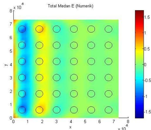
**Gambar 11.** *Photonic bandgap* pada Kristal fotonik 2D dengan parameter kisi  $r = 0,2a$ .
