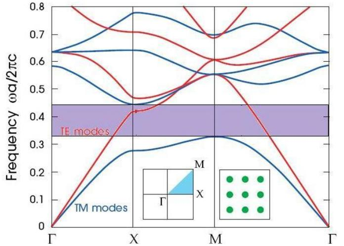
**Gambar 7.** Photonic bandgap pada Kristal fotonik 2D dengan parameter kisi  $r = 0,2a$  [5].
