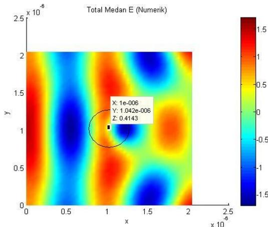
**Gambar 9.** Hamburan medan EM TM pada satu silinder dengan permitivitas silinder  $\epsilon_r = 4$  dan medium udara.
