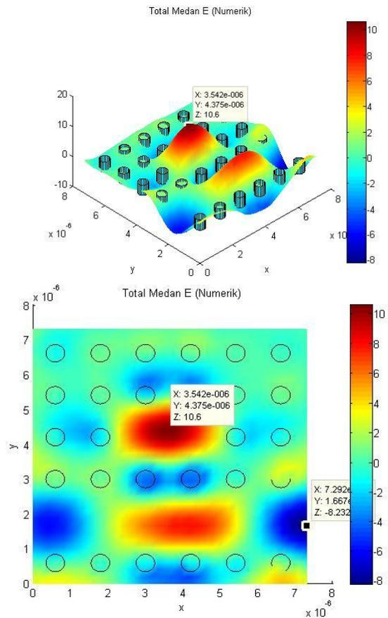
**Gambar 15** Simulasi kopling medan EM TM pada Kristal fotonik 2D dengan frekuensi  $\frac{\omega a}{2\pi c} = 0,38$
