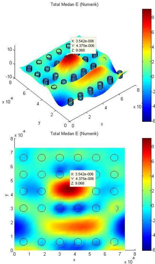
**Gambar 14** Simulasi kopling medan EM TM pada Kristal fotonik 2D dengan frekuensi  $\frac{\omega a}{2\pi c} = 0,37$
