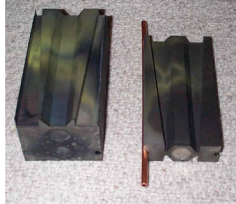
TRIUMF ISOL target Diffusion bonded Mo foils
