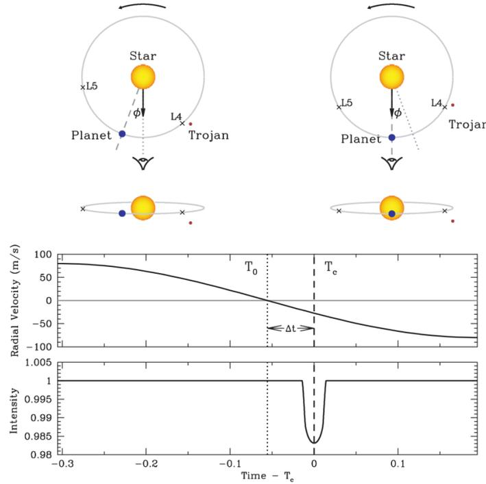
FIGURE 4.4 – Illustration de la méthode de Ford et Gaudi (2006). Le  $\phi$  représenté ici est identique à la phase de l'équation (4.3). Les graphes A et B représentent l'instant  $T_0$  où les vitesses radiales valent leur valeur moyenne et où la planète fictive passe par la ligne de visée. Les graphes C et D représentent l'instant  $T_e$  de transit effectif, où la planète  $m_1$  passe par la ligne de visée.
