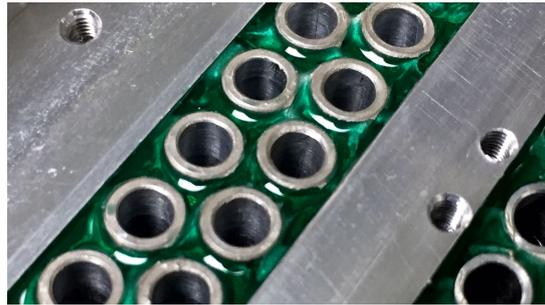
(d) Straws glued into the module.
