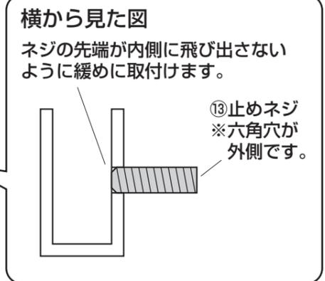
※同様に全てのシーリング取付け金具に止めネジを取付けます。
