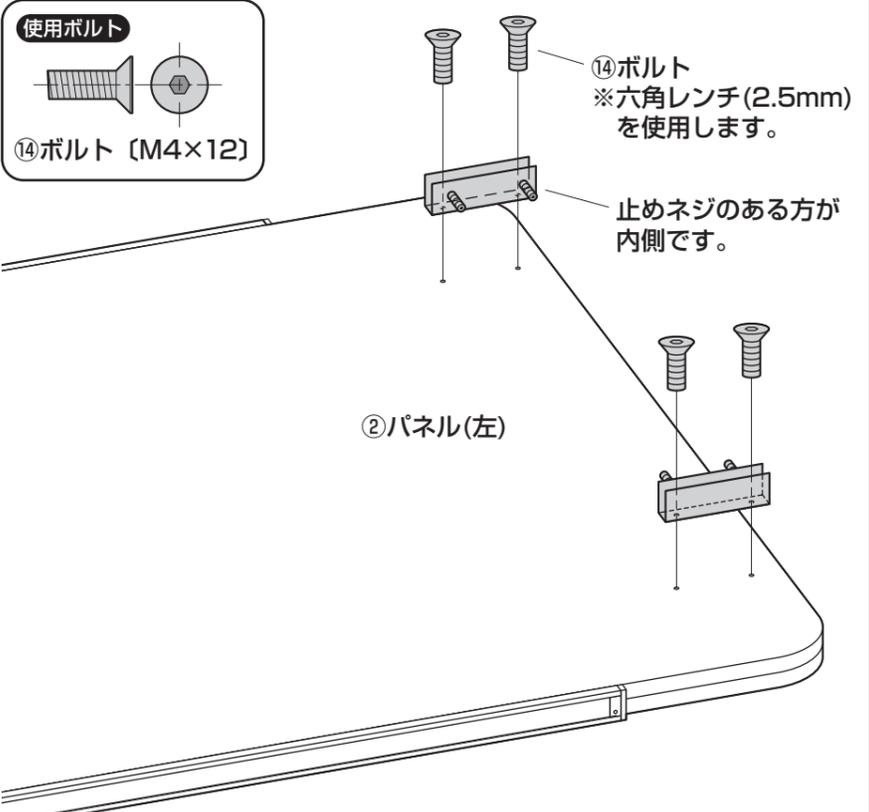
※同様にパネル(右)にもシーリング取付け金具を取付けます。
