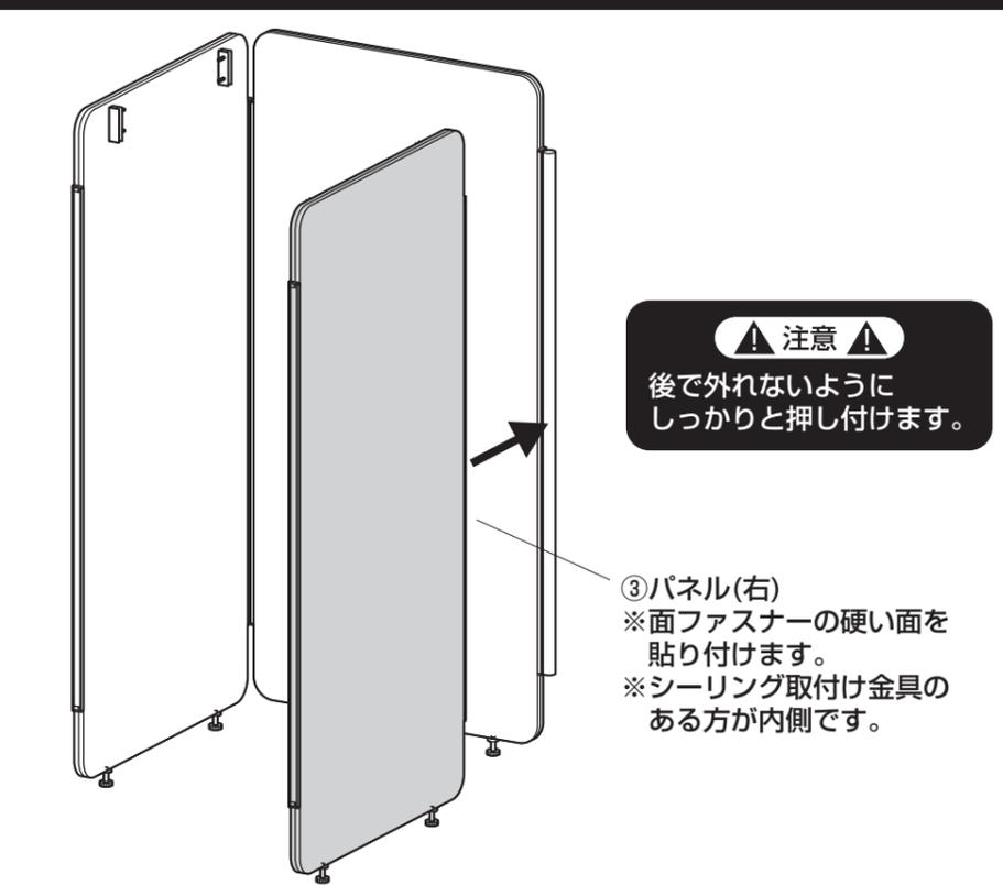
**8** シーリングパネルA、シーリングパネルBにシーリングパネルCを取付けます。
