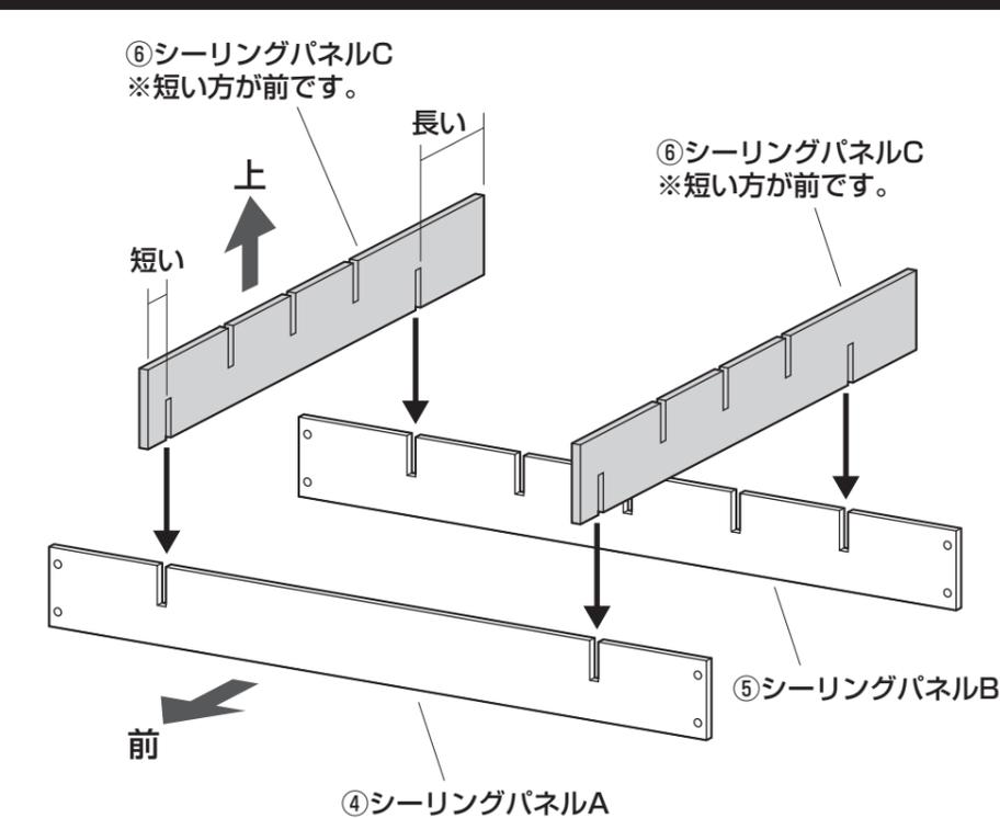
**9** シーリングパネルCにシーリングパネルDを取付けます。
