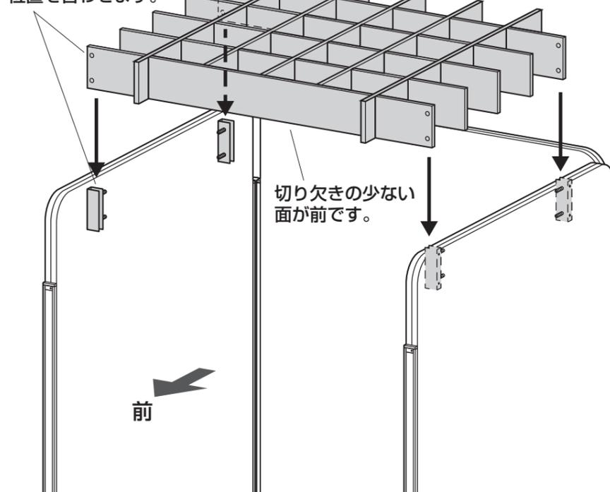
②止めネジを締め付けて固定します。
