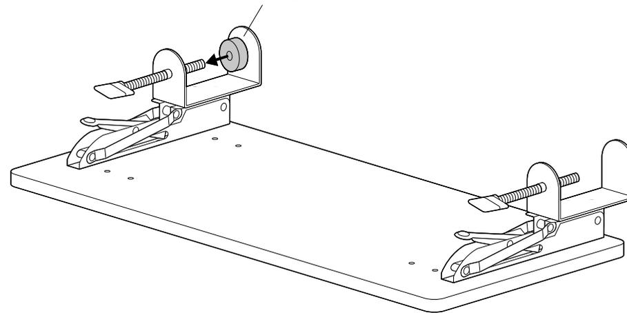
※同様にもう一方のノブボルトの先端にもクランプパットを取付けます。
