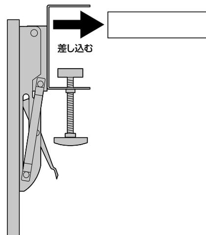
②ノブボルトを締め付けて固定します。
