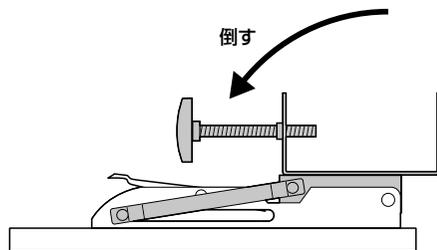
※左右両方のクランプを倒します。
