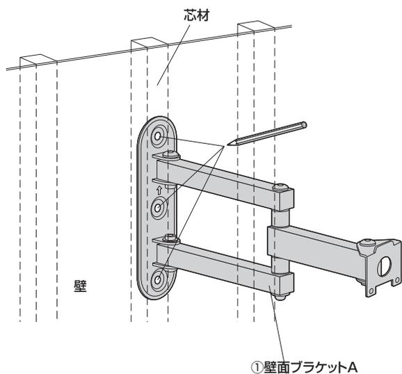
②ドリルを使い壁に印をつけた3ヶ所に直径4mm、深さ約60mmの下穴をあけます。
