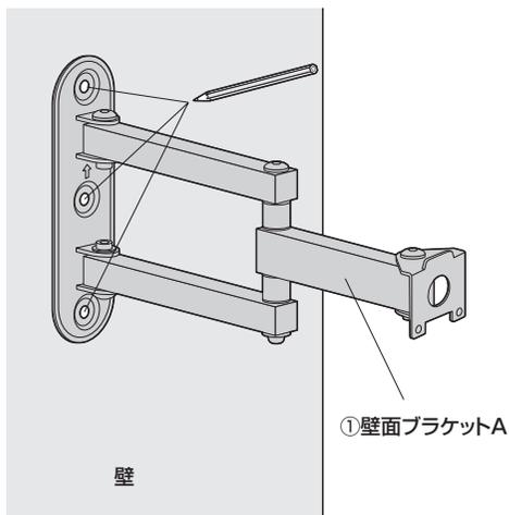
②ドリルを使い壁に印をつけた3ヶ所に直径10mm、深さ約60mmの下穴をあけます。
