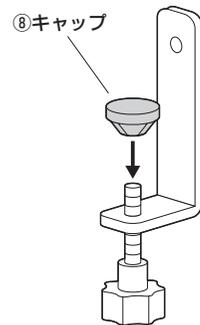
③本体をデスクなどの天板に設置し、クランプブラケットを取付けます。
