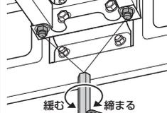
ブラケットの動きが重すぎたり、軽すぎる場合は六角レンチでボルトを回して調節します。※上下左右の4本ボルトを均等に回してください。
