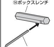
④ ボックスレンチでナットを回して調節します。
