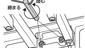
ブラケットの動きが重すぎたり、軽すぎる場合はボックスレンチでナットを回して調節します。※左右のナットを均等に回してください。
