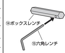
③ ボックスレンチでナットを回して調節します。
