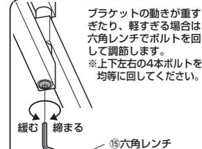
ブラケットの動きが重すぎたり、軽すぎる場合は下記の手順で調節します。※上下左右の4本のボルトを均等に調節してください。
