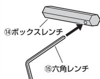
② ボックスレンチでナットを回して回さを調節します。
