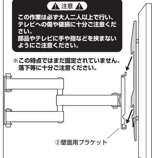
② テレビ用ブラケット下側のボルトを締め付けます。
