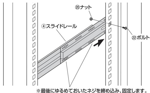
※最後にゆるめておいたネジを締め込み、固定します。
