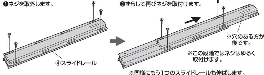
※マウントフレーム前面のスライドレールを取付ける位置にケージナットを取付けます。
