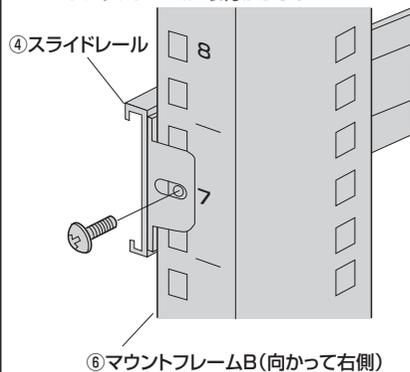
②後ろ側を取付けて固定します。
