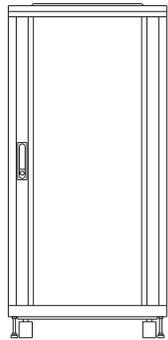
① 下側のナットを回してアジャスターを接地させます。
