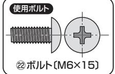
※ブラケットの先端(長い方)をフレームのスリットに差し込み、ボルトで固定します。
