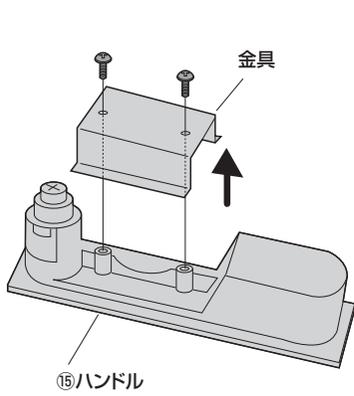
② 扉の穴にハンドルを差し込み、再び金具を取付けて固定します。
