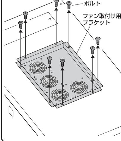
**3** ファン取付け用ブラケットにファン、フィルターキットを取付けます。
