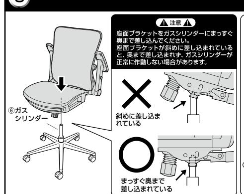
ガスシリンダーに座面ブラケットを差し込みます。
