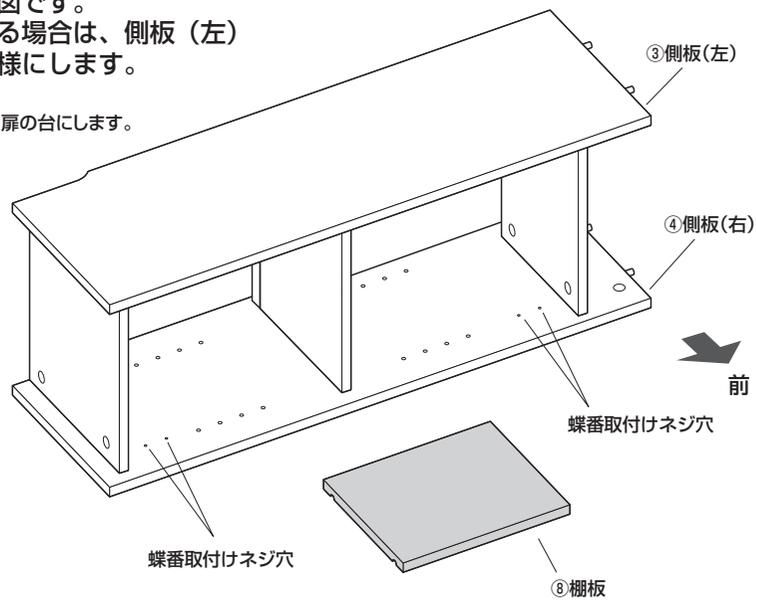
(2) 扉を棚板の上に置き、蝶番と取付けネジ穴を合わせて取付けます。
