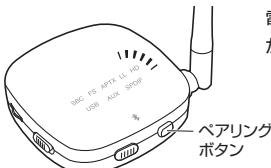
電源ONの状態で、ペアリングボタンを全てのLEDが点灯するまで長押しします。
