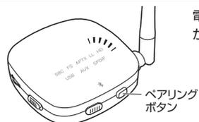
電源ONの状態、ペアリングボタンを全てのLEDが点灯するまで長押しします。
