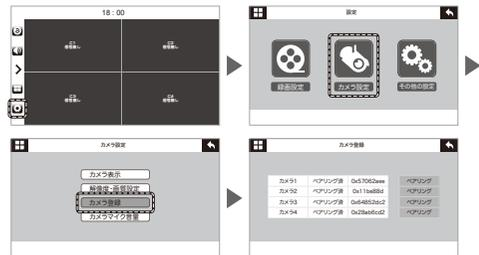
⑩登録するカメラ番号の「ペアリング」をリモコンで選択・決定、またはタッチしてください。「登録作業中...カメラの「ペアリング」ボタンを3秒間長押ししてください。」と表示されます。
