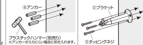
⑲ブラケットにカメラを取付けてください。カメラを設置する方向によって、上面・下面のブラケット取付け穴に取付けられます。
