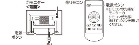
⑨モニターに「カメラ登録」画面を表示させてください。リモコンの方向ボタン(▲▼▶◀)でカーソル移動、OKボタンで決定、またはモニター画面をタッチして下記の順番で操作してください。
