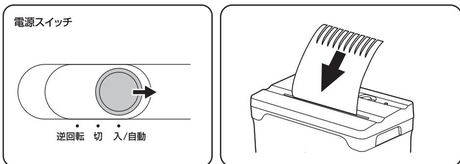
3. 終了後は、必ず電源スイッチを“切”に合わせて電源プラグを抜いてください。
