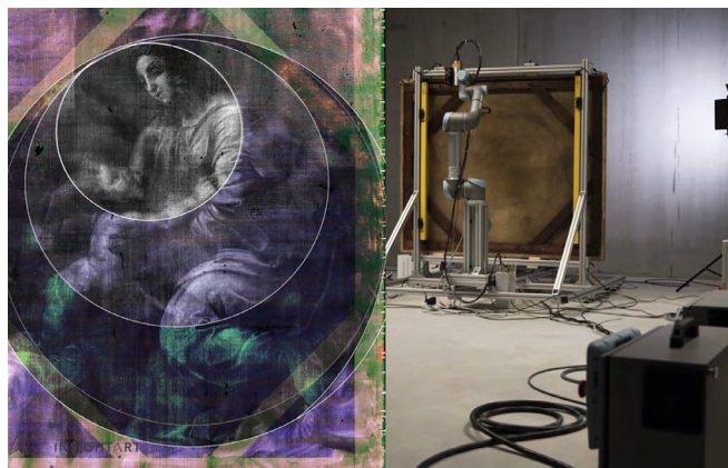
En haut à gauche : Image combinant des spectres d'énergie mesurés par le scanner Rtoo. En haut à droite : Le scanner Rtoo scannant La Vierge à l'enfant.
