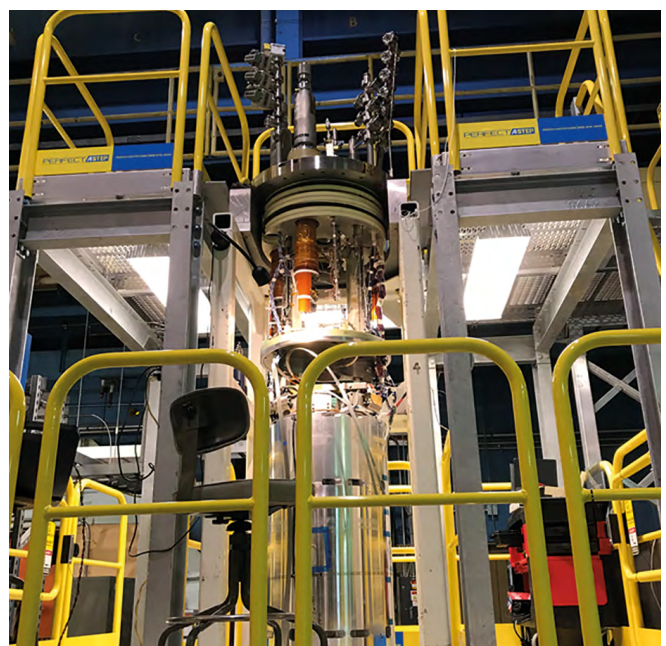
Un aimant quadripôle en niobium-étain pour le projet HL-LHC a atteint un champ magnétique record de 11,4 T lors d'un test au Laboratoire national de Brookhaven, aux États-Unis.
