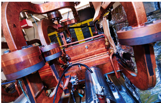
Détail d'un prototype de collisionneur linéaire compact, technologie sur laquelle repose la conception de la future installation FLASH. (CERN-PHOTO-202008-108-13)
