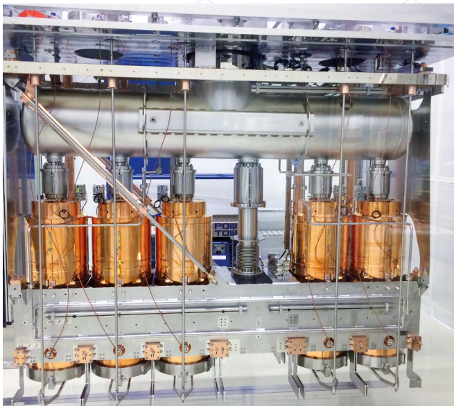
L'un des quatre cryomodules de HIE-ISOLDE avec ses cinq cavités radiofréquence. (OPEN-PHO-ACCEL-2016-016-7)
