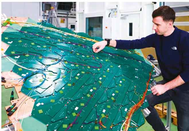
Maquette pour tester l'assemblage des modules d'une tranche du calorimètre à haute granularité de CMS.
