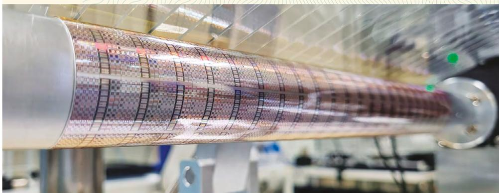
Le nouveau détecteur de vertex d'ALICE fait appel à des capteurs pixels qui peuvent être incurvés pour s'adapter à la géométrie cylindrique du détecteur.
