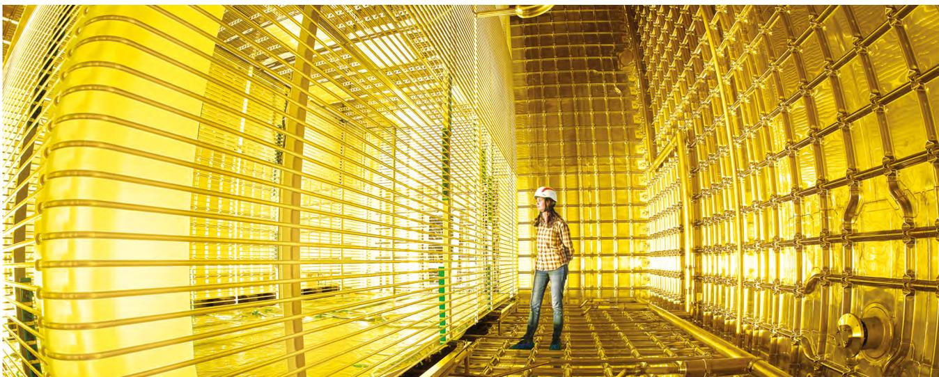
Une chambre à dérive verticale a été installée dans un cryostat des prototypes de DUNE. (CERN-PHOTO-202308-195-28)
