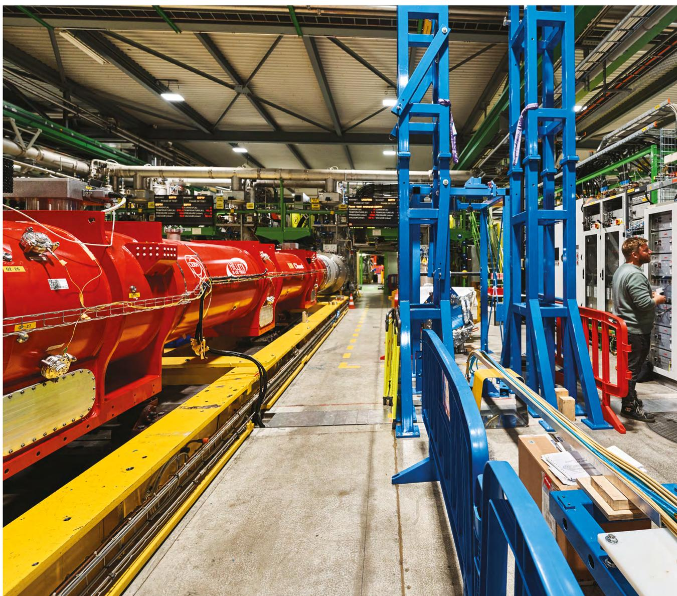
Le premier prototype d'aimant dipôle de séparation et de recombinaison D2, fabriqué en Italie sous la direction de l'institut italien de physique des particules INFN, a été testé au CERN.
