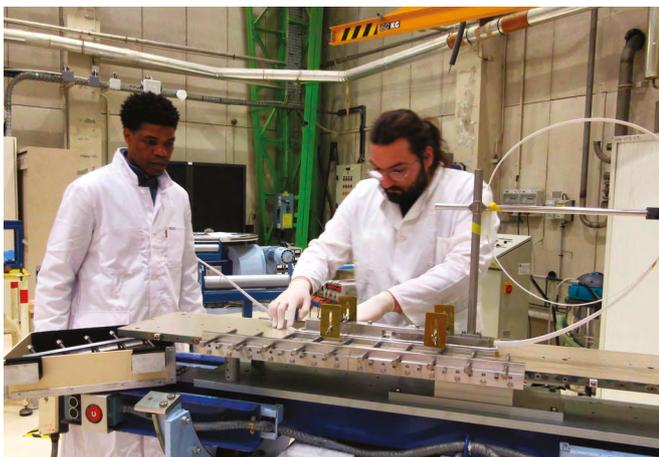
Fabrication d'une bobine prototype au CEA (France), dans le cadre d'une collaboration CERN-CEA sur le développement des aimants à champ élevé à base de supraconducteur niobium-étain.
