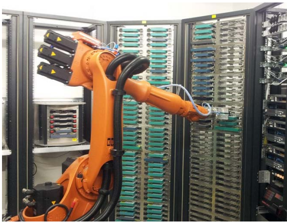
Рис. 5. Фото хранилища с роботом-загрузчиком
