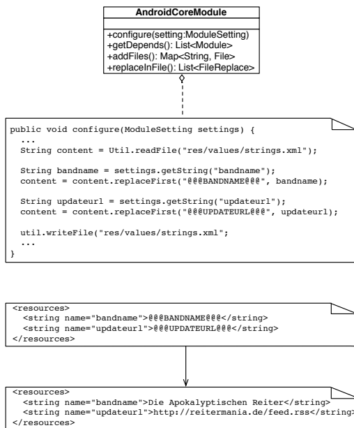
Abbildung 4: Beispiel für die XML-basierte Transformation eines Android-Code-Skeletts
