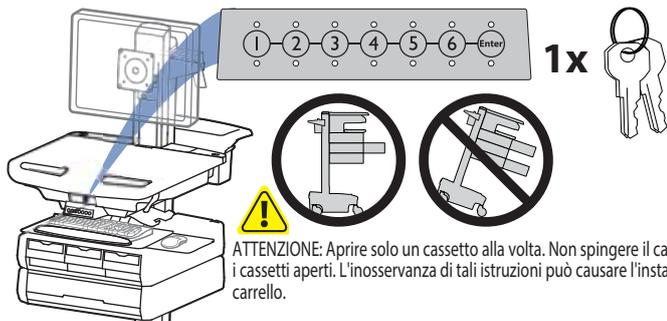
**ATTENZIONE:** Aprire solo un cassetto alla volta. Non spingere il carrello con i cassetti aperti. L'inosservanza di tali istruzioni può causare l'instabilità del carrello.
