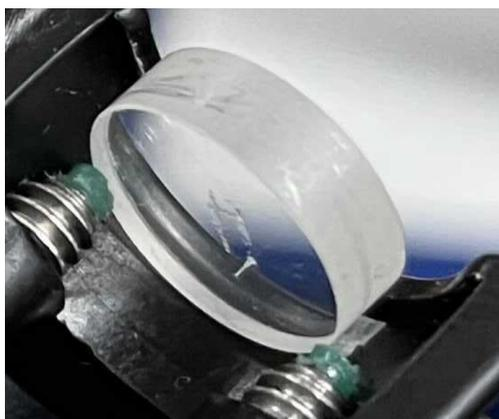
図 7.15: 結晶に損傷が入ってしまった様子
