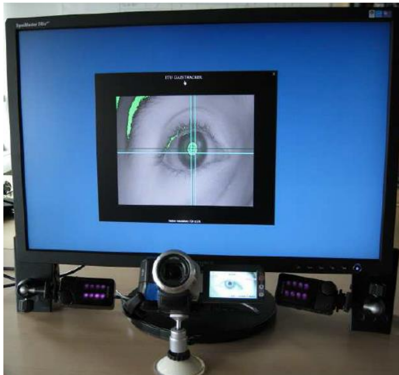
Figura 9: Eye tracker con una videocámara de visión nocturna y dos fuentes de luz infrarroja [12].
