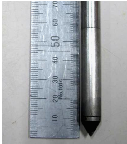
Fig. 17. Miniature cone penetrometer.
