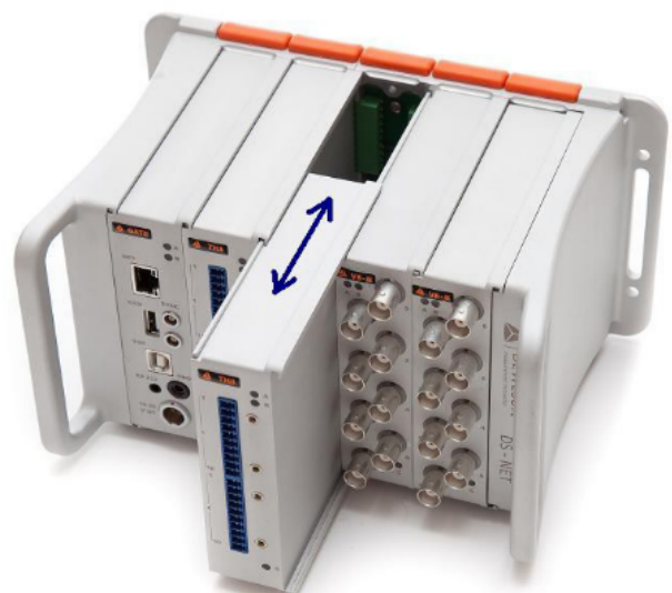
Illustration 302: DS NET: insert/remove module
