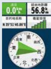
地磁気を感じし、即座に方角を示してくれます。3軸コンパスは斜めに持っても正しい方角を示す。
