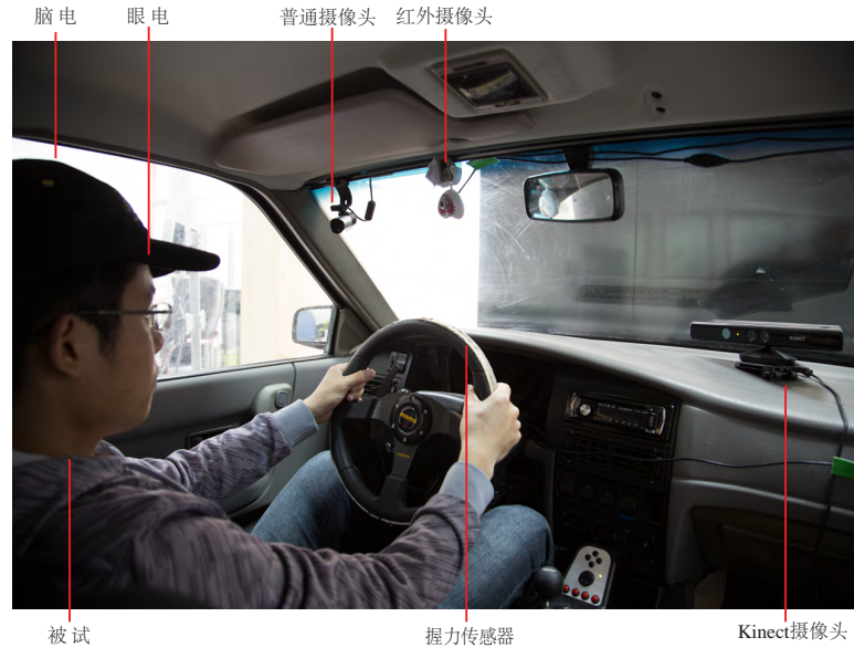
图 5-1 基于视频与握力信号驾驶员的疲劳驾驶实验环境示意图
