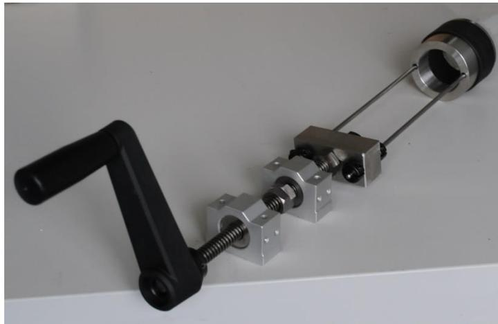
Abbildung 53: Vormontierte Spannvorrichtung - Einzelansicht
