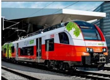
BEMU: Siemens Cityjet eco (Prototypumbau eines EMU Desiro ML) (Quelle: Siemens 2018)
