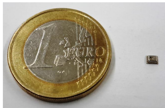
Abbildung 22 Größenvergleich von 1 Euro Münze und BMP280 MEMS-Drucksensor.
