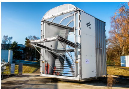
Abbildung 16: SoCRatus-Teststand des DLR zur Untersuchung photokatalytischer und photo-elektrochemischer Systeme unter konzentrierter Solarstrahlung. [102]
