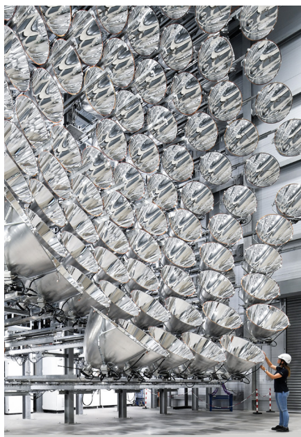
Abbildung 18: Hochleistungsstrahler Synlight des DLR in Jülich, die weltweit größte Forschungsanlage mit künstlicher konzentrierender Solarstrahlung. Ende 2019 wurde hier im Rahmen des Projekts INDIREF ein solarer Reformierungsreaktor erfolgreich getestet.
