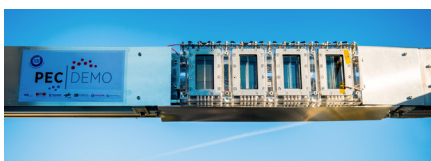
Abbildung 17: Hybride photo-elektrochemisch-photovoltaische Zelle (PEC-PV) des Projekts PECDEMO. [102]
