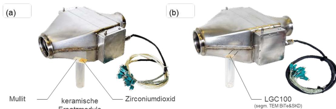
Abbildung 2-25 TEG-Funktionsmuster als Hardwarerealisierung des TEG-Ergebnisdesigns mit Zielsetzung minimaler TCO: (a) HDTEG1: Aufbau mit Ersatzmodulen und (b) HDTEG2: Aufbau mit TEM LGC100 der Firma LG Chem
