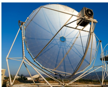
Abbildung 1-2: Dish-Anlage (Quelle: DLR/Ernsting)
