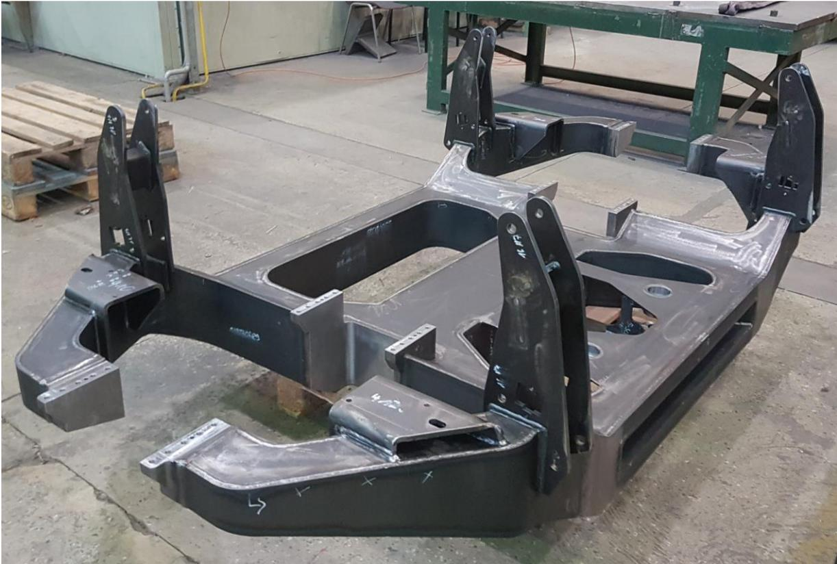
**Bild 9 – Gefertigtes, unlackiertes Exemplar des Radträgers nach dem Richten und der spanenden Bearbeitung**
