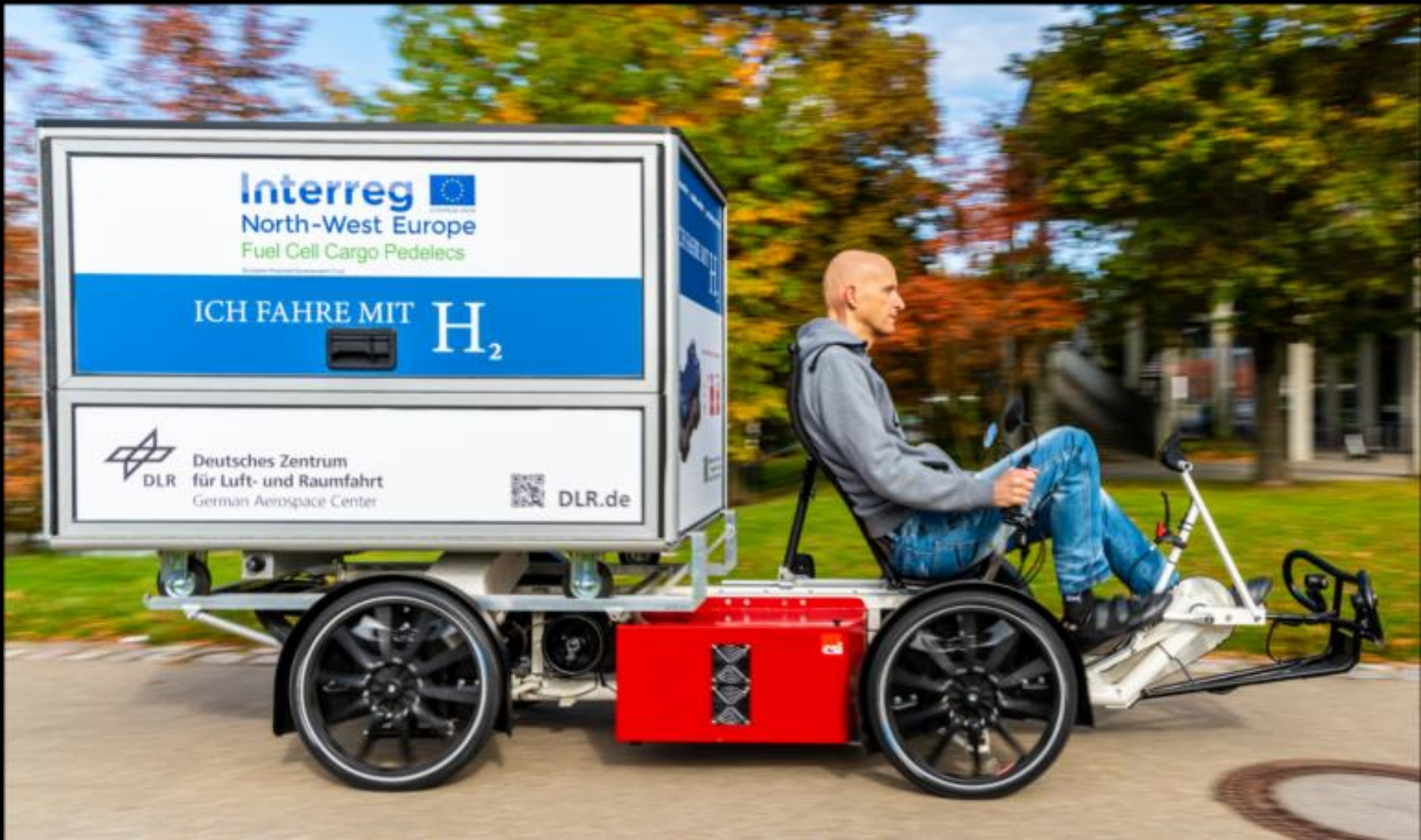
Wasserstoff Lastenfahrrad. Reichweite ca. 150km. Foto: Unicorn engineering GmbH & DLR
