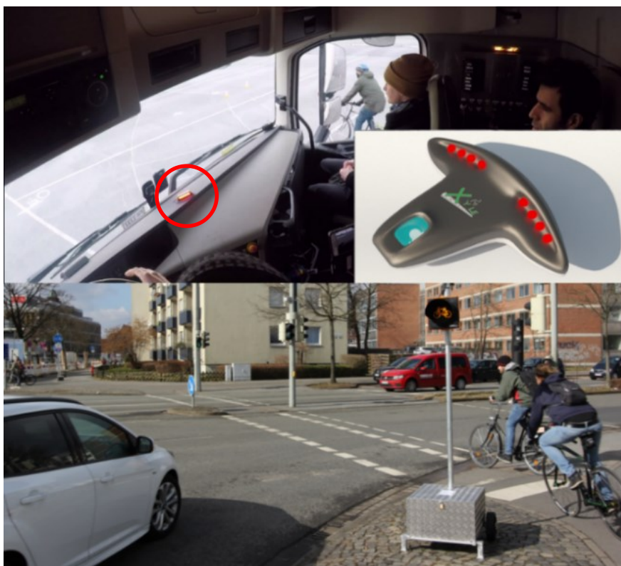
Abbildung 56: Warnsysteme des integrierten XCYCLE Demonstrators. Oben: fahrzeuggestützte Warnsysteme für LKW und Radfahrer, unten: adaptiver Schutzblinker aus (XCYCLE Konsortium 2018a, 2018b)
