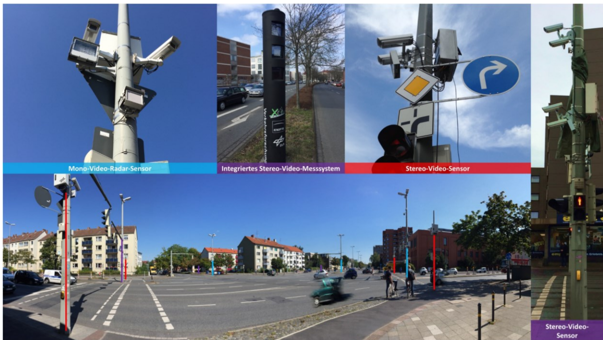
Abbildung 45: AIM Forschungskreuzung, eingesetzte Sensortechnologien Stand Februar 2020 aus (Arndt 2018b)
