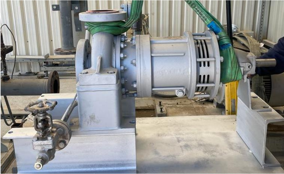
Figura 39. Foto de la bomba de HTF desmontada, en 2023 [Cortesía de DLR].
