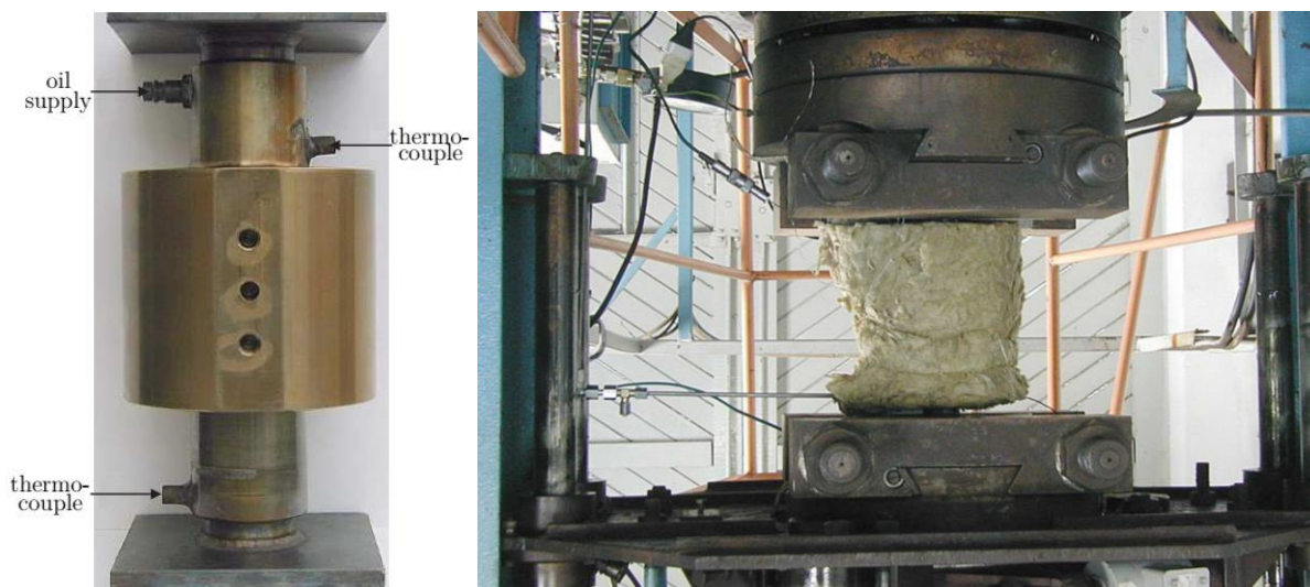
Figura 19. SJ de IRAtec mostrando las placas de sujeción y los orificios de medida y alimentación (izq.), y una SJ con calorifugado en el banco de ensayos de IRAtec (der.) [10].
