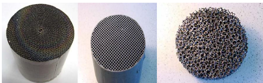
Abbildung 3.5: Poröse Materialien für volumetrische Solarreceiver
